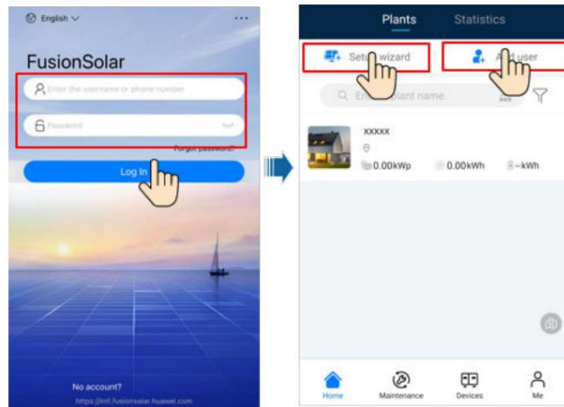
Figure 7-5 Création d'une installation photovoltaïque et d'un utilisateur
